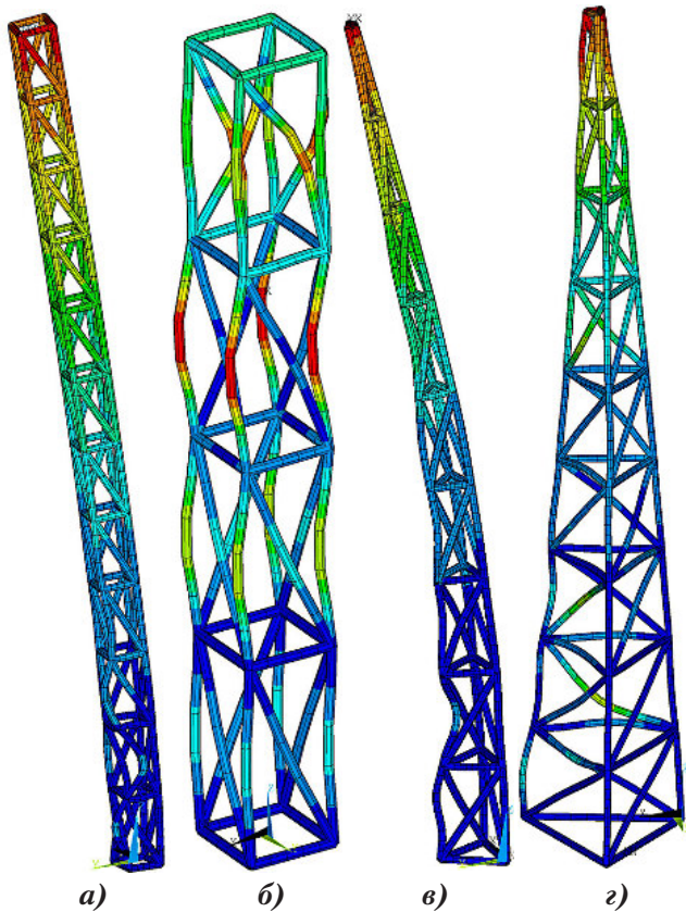
Рис. 6. Формы колебаний проектов конструкции с параллелепipedными секциями с параметрами R = 2 м, k_p = 20 (а); R = 11 м, k_p = 4 (б) и пирамидальными секциями с параметрами R = 0,5 м, k_p = 3 (в); R = 7 м, k_p = 7 (з)
