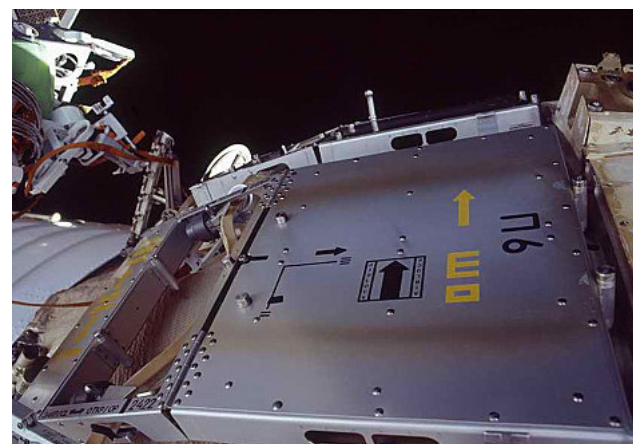
Рис. 7. Дополнительные противоосколочные панели после установки
