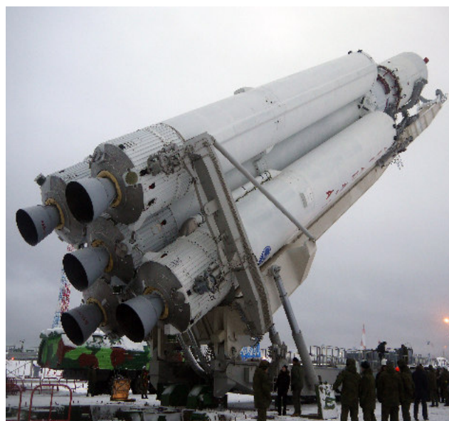
Рис. 7. Подготовка РН «Ангара-5» с ЖРД РД-191 к пуску на космодроме «Плесецк»
