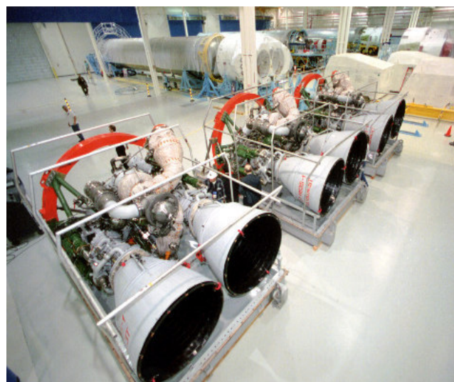
Рис. 6. Жидкостный ракетный двигатель РД-180 перед сборкой с РН «Атлас» в США
