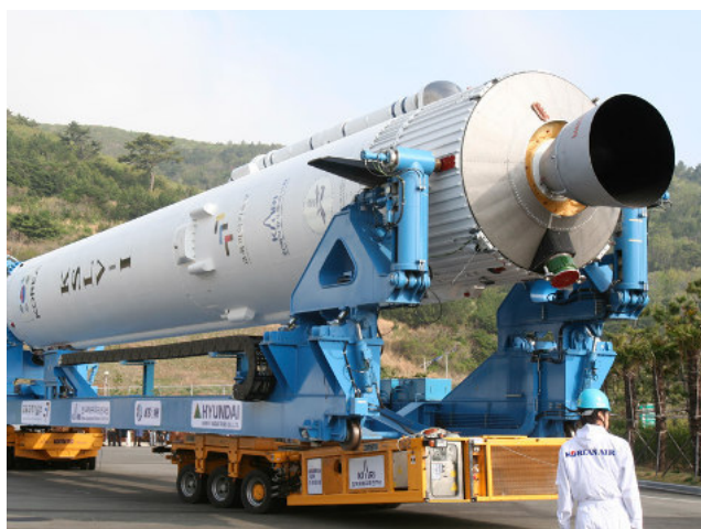
Рис. 8. Российский ЖРД РД-151 в составе южнокорейской ракеты-носителя KSLV-1
