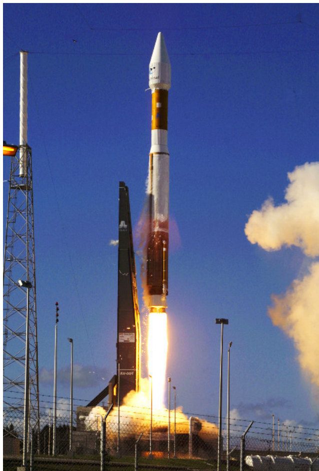
Рис. 5. Пуск американской РН «Атлас-5» с российским двигателем РД-180 на первой ступени
