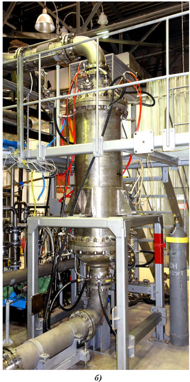
Рис. 8. Резистивный нагреватель газа: а – схема; б – внешний вид; 1 – охлаждаемые герметичные токовые вводы; 2, 9 – патрубки для подвода и отвода нагреваемого газа; 3, 5, 13 – кожухи с каналами водяного охлаждения; 4, 12 – внешний герметичный корпус, состоящий из цилиндрической части и двух крышек эллипсоидной формы; 6, 8 – негерметичные внутренние экраны; 7 – слой теплоизолирующего материала; 10 – внутренняя полость, предназначенная для нагрева в ней газа; 11 – отверстия несущих фланцев; 14 – негерметичные трубки; 15 – электрические шины
