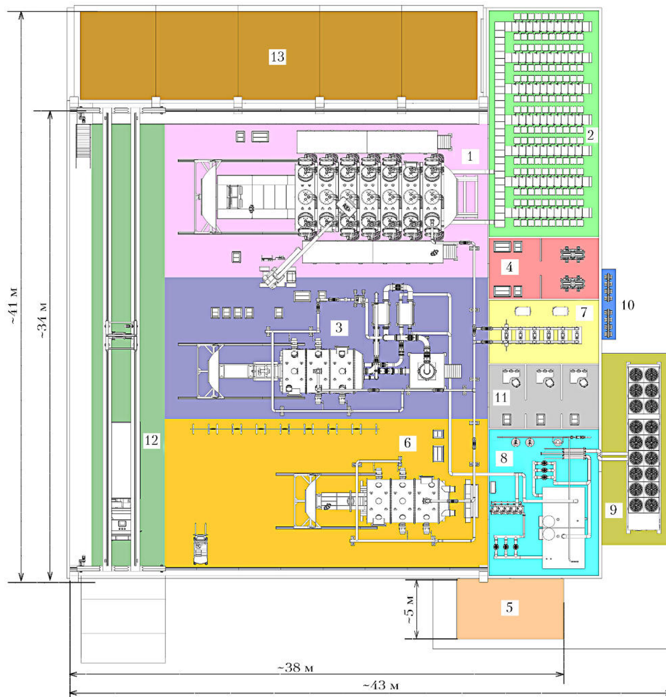
Рис. 2. План стендовой базы для наземного демонстратора: 1 – участок для испытаний электроракетных двигателей; 2 – участок компрессоров криогенных насосов; 3 – участок для проведения испытаний контура преобразования энергии; 4 – участок системы электропитания и управления резистивным нагревателем газа; 5 – участок тепловыделяющих элементов балластной нагрузки; 6 – участок для испытаний холодильника-излучателя; 7 – участок форвакуумной станции; 8 – участок системы оборотного водоснабжения и водоподготовки; 9 – участок системы охлаждения оборотного водоснабжения; 10 – участок газовой ramпы высокого давления; 11 – участок комнаты управления; 12 – участок разгрузки/погрузки; 13 – офисные помещения
