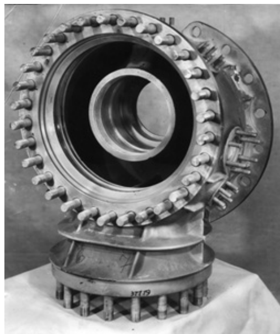
Рис. 1. Сегмент турбонасосного агрегата (с жаростойкой эмалью) двигателя НК-33. Материал сегмента — жаропрочный никелевый сплав ЭП202
