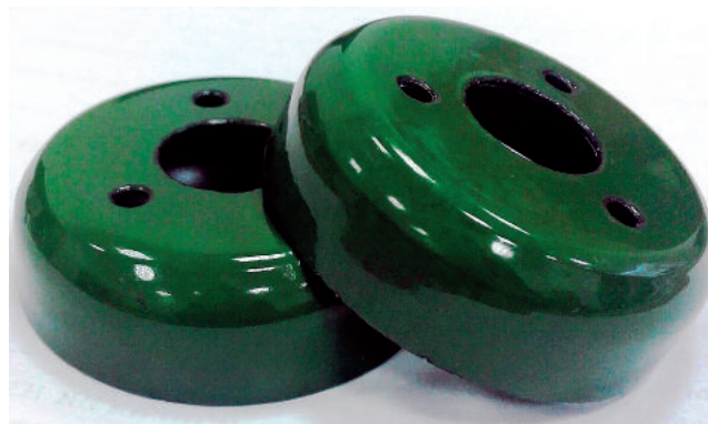
Рис. 6. Изделие типа «чашка» из стали 12X18H10T со стеклокерамическим покрытием
