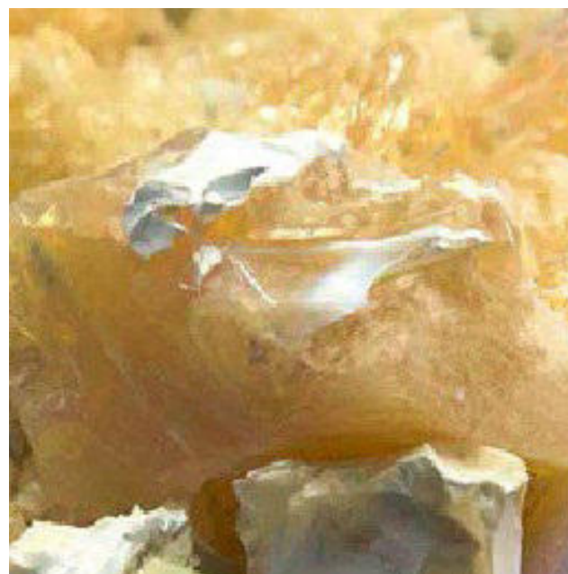
Рис. 3. Внешний вид стекол (фритт) системы BaO-Al_2O_3-SiO_2
