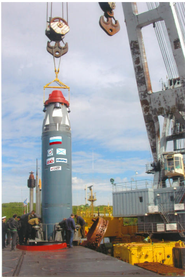
Рис. 7. Погрузка морской РН «Штиль» в шахту для последующего запуска германского спутника «Тубсат»
