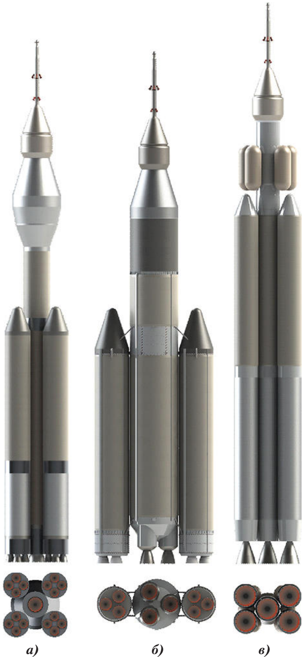
Рис. 11. Результаты проектно-конструкторских исследований ракет-носителей тяжелого и сверхтяжелого классов: а — M_0 \sim 2\,060\text{ т} , M_{\text{пн}} на НОО \sim 93\text{ т} , тип двигателей — I-РД171МВ, II-РД0120; б — M_0 \sim 1\,920\text{ т} , M_{\text{пн}} на НОО \sim 108\text{ т} , тип двигателей — I-РД0164, II-РД0120; в — M_0 \sim 1\,650\text{ т} , M_{\text{пн}} на НОО \sim 85\text{ т} , тип двигателей — I-РД0750Ф, II-РД0146
