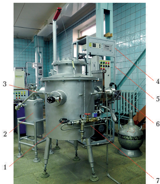
Рис. 4. Установка для исследования газовой выделению в вакууме: 1 — напускной вентиль; 2 — цеолитовый насос; 3 — вакуумная камера; 4 — средства измерения давления в камере; 5 — пульт управления средствами откачки; 6 — турбомолекулярный насос; 7 — система охлаждения
