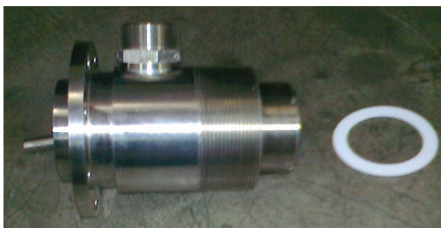
Рис. 2. Изготовленный струйный насос-конденсатор
