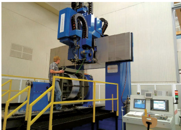
Рис. 2. Установка для сварки трением с перемешиванием PowerStir 345C
