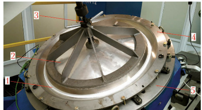
Рис. 8. Расположение крышки в приспособлении для сварки: 1 – сварной шов; 2 – оболочка; 3 – прижим; 4 – прижимное кольцо; 5 – вращатель
