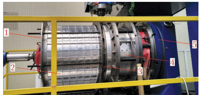
Рис. 9. Приварка шлангоутов к оболочке: 1 – прижим; 2 – обечайка; 3 – хомут; 4 – разжимной механизм; 5 – вращатель
