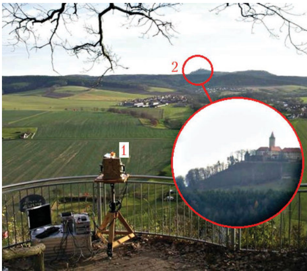
Рис. 1. Испытания ЛЛС специалистами Jena Optronic в долине реки Заале [17]: 1 – ЛЛС; 2 – удаленные постройки, используемые в качестве мишени
