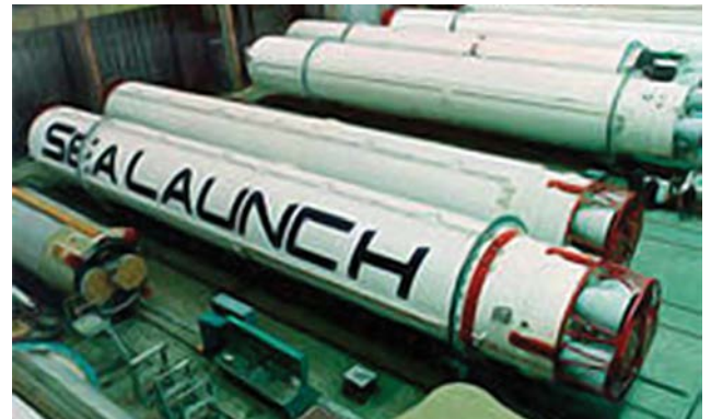
Рис. 4. Ракета «Зенит» (первые две ступени) в трюме сборочно-командного судна
