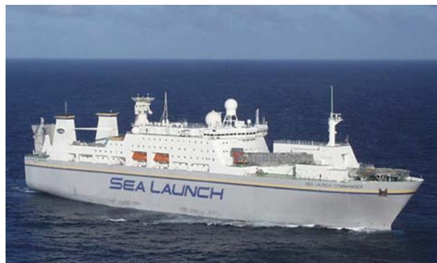
Рис. 2. Сборочно-командное судно. Параметры: длина — 203 м; ширина — 32 м; высота — 40 м; водоизмещение — 30 800 т; скорость — 16 узлов
