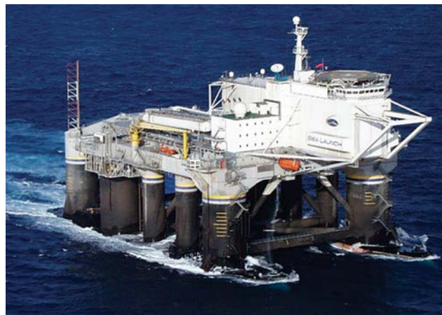
Рис. 1. Стартовая платформа комплекса «Морской старт». Параметры: длина — 133 м; ширина — 67 м; высота — 62 м; водоизмещение — 46 000 т; скорость — 12 узлов
