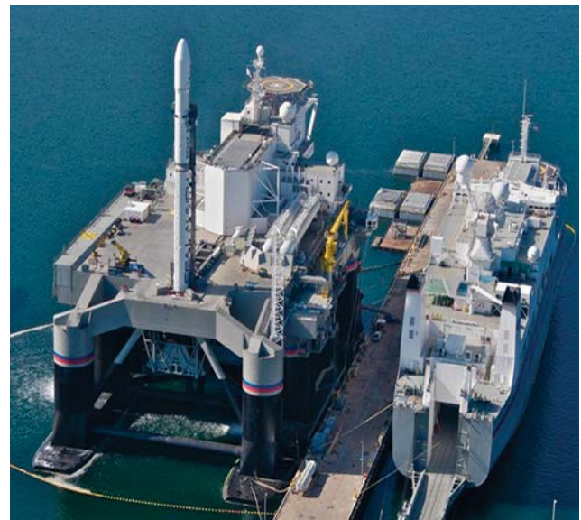
Рис. 7. Синхронное плавание сборочно-командного судна и стартовой платформы
