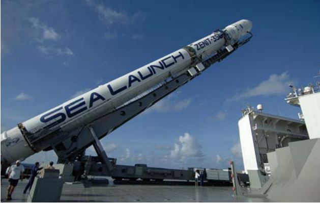
Рис. 8. Поднятие ракеты в вертикальное положение
