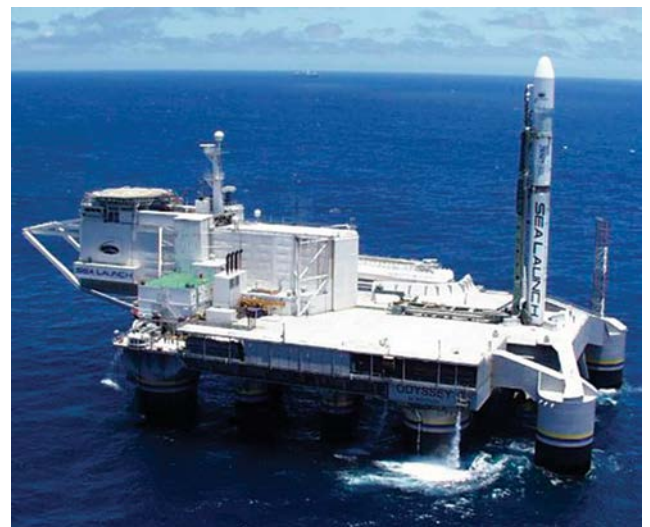
Рис. 5. РКН «Зенит-3SL». Параметры: высота — 59 652 м; диаметр ракеты — 3,9 м; диаметр блока полезного груза — 4,150 м; стартовая масса — 472 910 кг; масса БПГ — 8 246 кг
