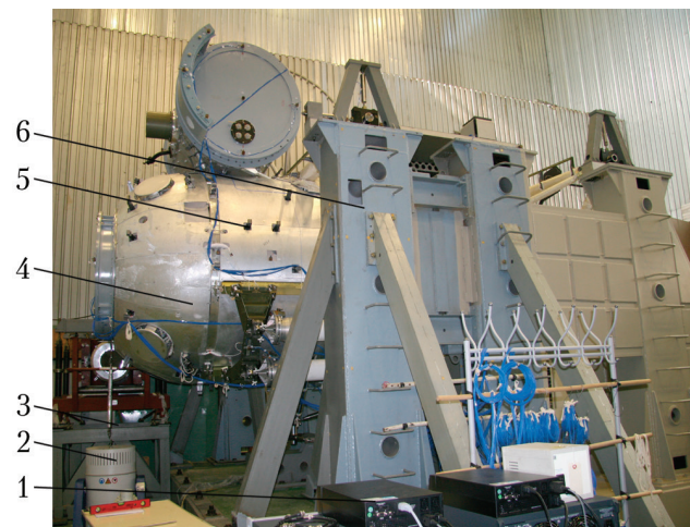
Рис. 1. Экспериментальная установка для модальных испытаний динамического макета МИМ1 при условии нагружения в направлении вертикальной оси: 1 – блоки системы управления нагружением, измерения и обработки данных; 2 – электродинамический вибратор; 3 – шток электродинамического вибратора, снабженный измерителем усилия; 4 – объект испытания (динамический макет МИМ1); 5 – акселерометр системы измерения, установленный на объекте испытаний; 6 – силовая оснастка для закрепления объекта испытаний
